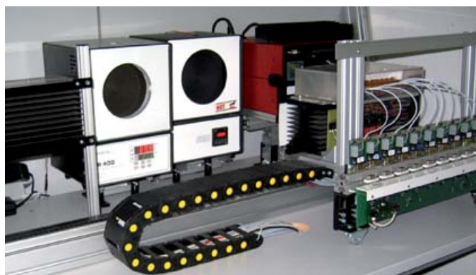
Automatisierte Kalibrierstation bei der Optris GmbH
