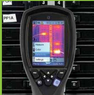
FLIR i3, Temperaturerfassung an 3600 Punkten
