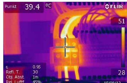
Hier ist eine auffällige Leitung oder Klemme zu sehen. Der Systembetreiber sollte die Ursache abklären.
