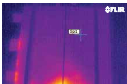
Das Wärmebild zeigt, dass diese Zelle Fehler in der Kantenisolation aufweist, wodurch lokale Kurzschlüsse entstehen.
