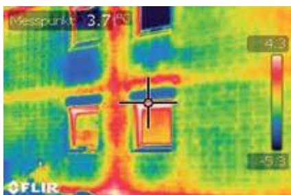
Beispiele einer ineffizienten Leitungsisolierung zwischen einer Küche und einem Badezimmer
