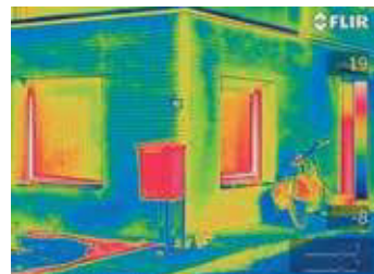
Wärmebild desselben Gebäudes, jetzt mit der MSX-Funktion. Beachten Sie, dass jetzt mehr Details sichtbar sind. Dadurch lassen sich Lüftungsgitter einfacher lokalisieren und die Backsteinstruktur wird erkennbar.
