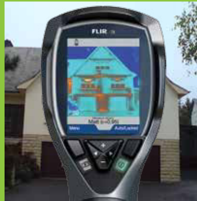
FLIR i3, Temperatur an 3600 Punkten
